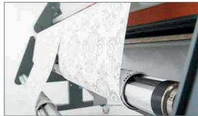
Système de rembobinage avant : il rembobine le support coupé jusqu'à 3 petits rouleaux
