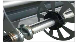
Arbre de déroulement robuste pour rouleaux ø 400mm jusqu'à 90 kg
