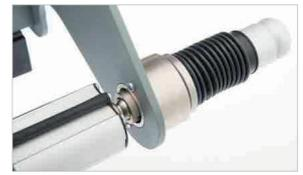
Frein d'arbre de déroulement pour régler la pression du matériau
